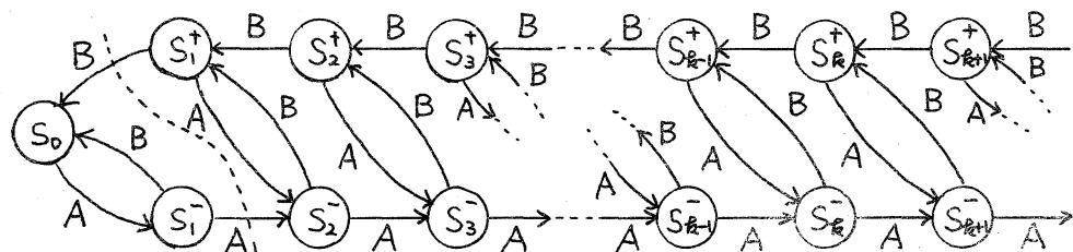
Fig.2 状態遷移のフローラフ
