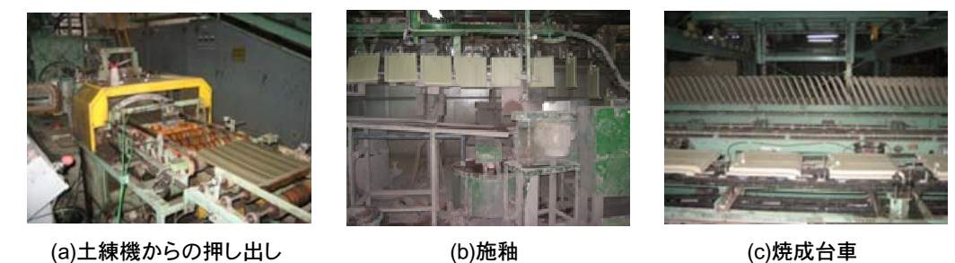
写真 2.4.4 陶器平板瓦（釉薬平板瓦）の製造工程
