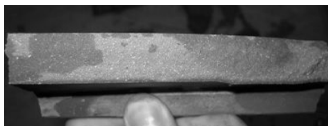
写真 6.4.1 いぶし瓦に特徴的な含水率分布
