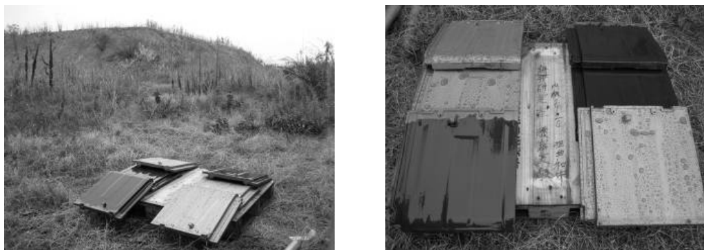
写真 6.2.8 曝露実験における瓦の設置状況
