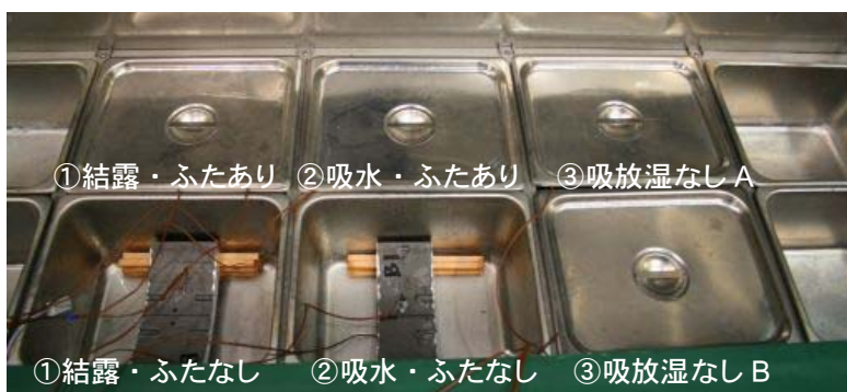
写真 2.5.3 CIF/CDF 試験機内の瓦試料
