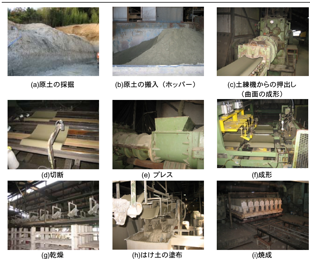
写真 2.4.3 和形いぶし瓦の製造工程
