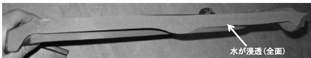
写真 6.2.7 釉薬瓦内部の水分分布（3日後）
