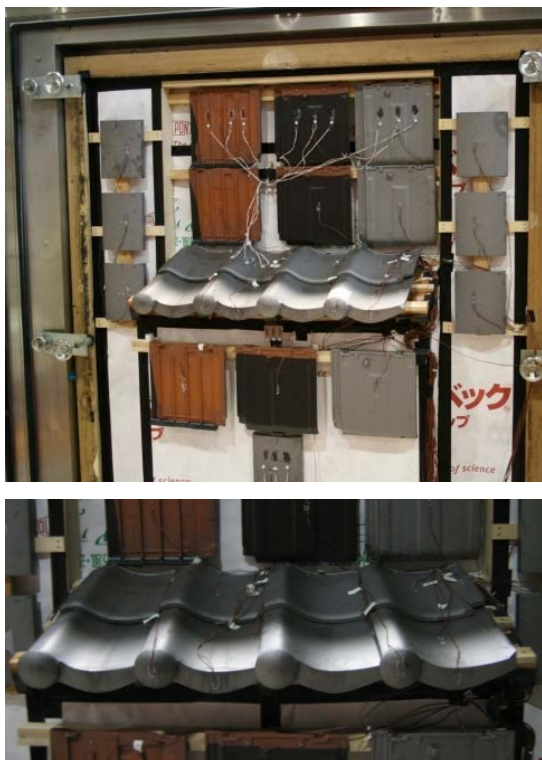
写真 2.5.8 複合劣化試験体の外観
