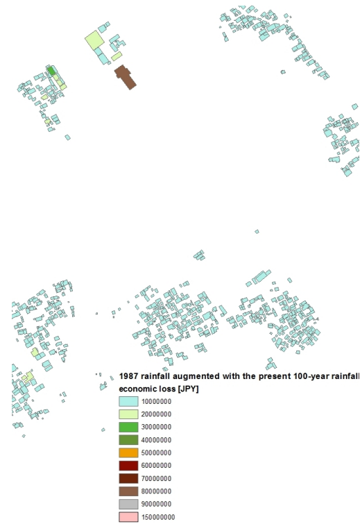
図 5.25 1987年降雨イベントを現在の100年確率日雨量相当に引き伸ばした降雨による各戸の被害額を推定した結果
