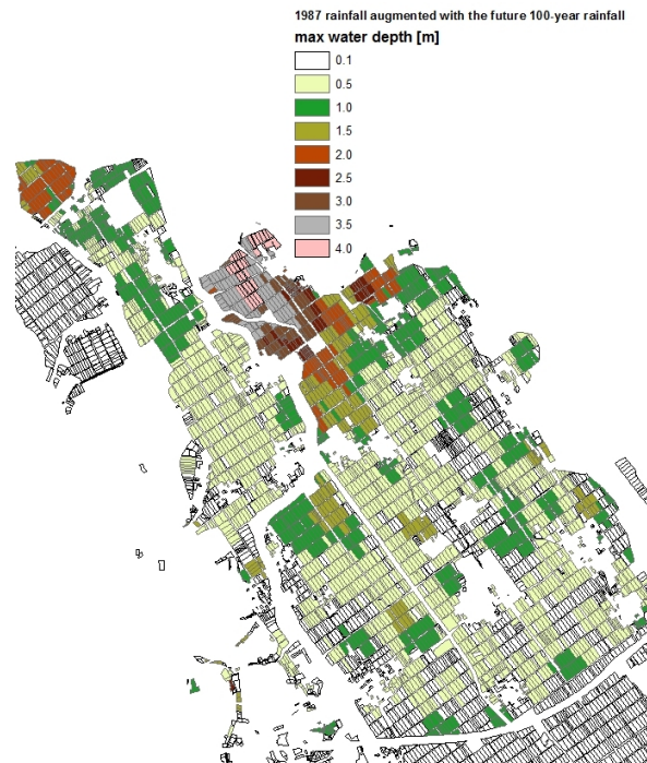
図 5.14 1987年降雨イベントを将来の100年確率日雨量相当に引き伸ばした降雨により農地の最大浸水深を推定した結果
