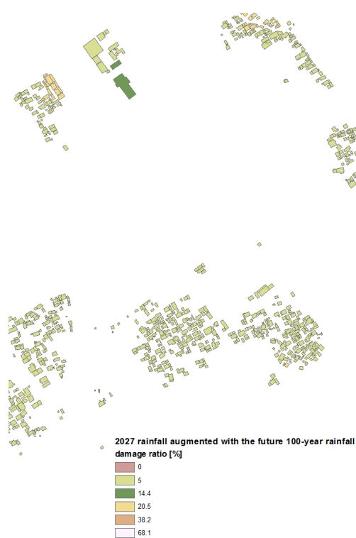
図 5.20 2027 年降雨イベントを将来の 100 年確率日雨量相当に引き伸ばした降雨により家屋の被害率を推定した結果
