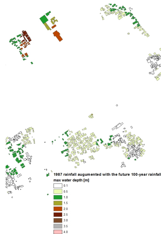
図 5.10 1987 年降雨イベントを将来の 100 年確率日雨量相当に引き伸ばした降雨により家屋の最大浸水深を推定した結果
