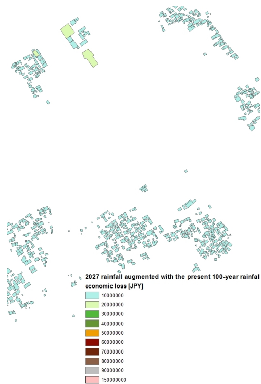
図 5.27 2027 年降雨イベントを現在の 100 年確率日雨量相当に引き伸ばした降雨による各戸の被害額を推定した結果
