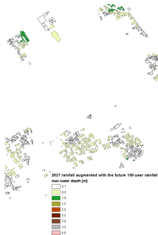
図 5.12 2027 年降雨イベントを将来の 100 年確率日雨量相当に引き伸ばした降雨により家屋の最大浸水深を推定した結果
