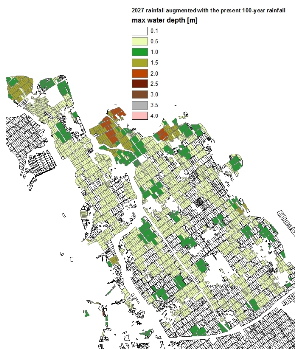
図 5.15 2027 年降雨イベントを現在の 100 年確率日雨量相当に引き伸ばした降雨により農地の最大浸水深を推定した結果
