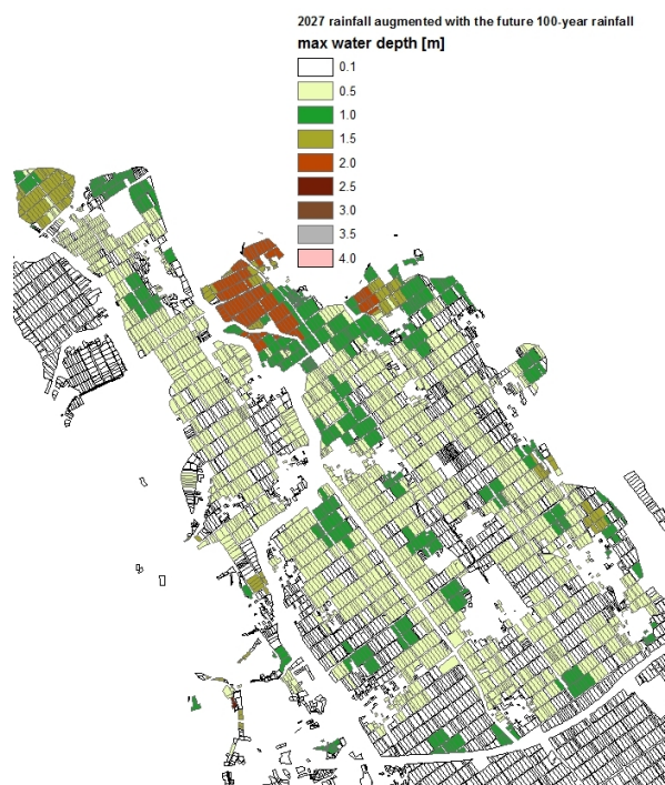
図 5.16 2027 年降雨イベントを将来の 100 年確率日雨量相当に引き伸ばした降雨により農地の最大浸水深を推定した結果
