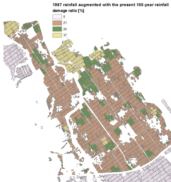
図 5.21 1987 年降雨イベントを現在の 100 年確率日雨量相当に引き伸ばした降雨により農地の被害率を推定した結果
