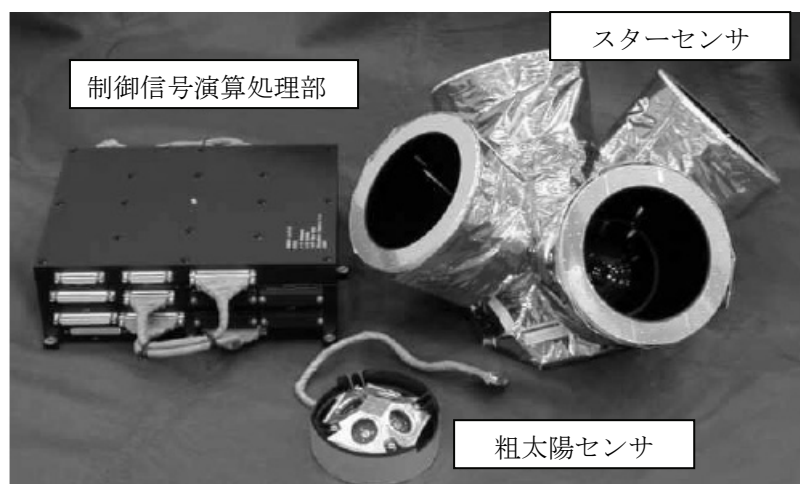
図(付録)- 1 スターセンサ統合型衛星制御装置 SIS の概観写真
