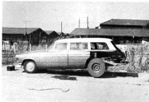
写真一 2 4 ウインチドラム（クライスラー後輪改造）
