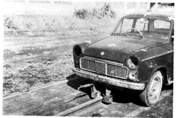
写真-2.2 車体にとりつけたガイドローラと先端フック
