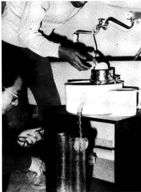
図4.9 定水位透水法による細骨材の表面積の測定状況
