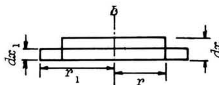
図 6.4 村田らによるスランブ試験の円板要素の変形 6-11)
