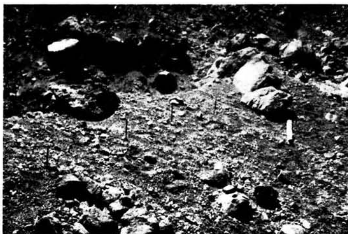
写真 2-7 鉄棒による侵食深の調査
