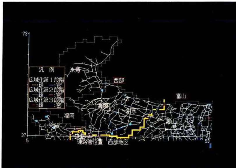
図7・1（b） 富山県西部における主要管路図及び設定連絡管位置
