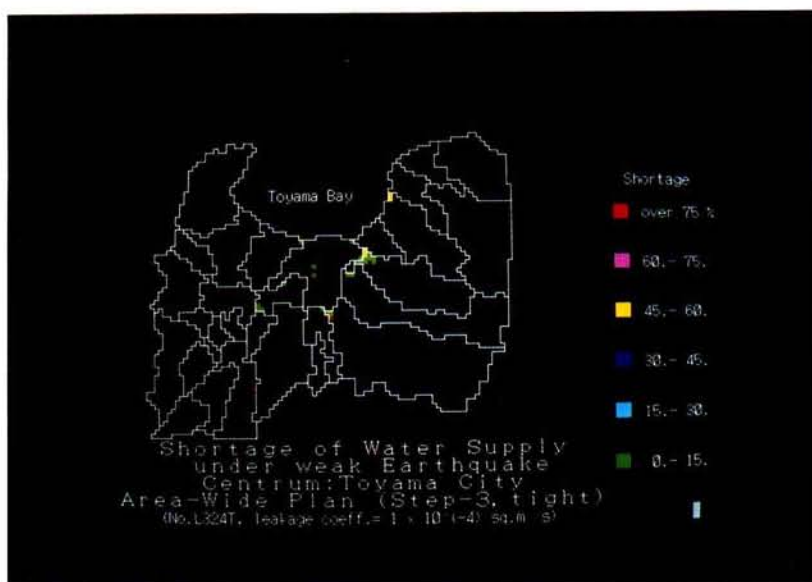
図7・5（b） 富山市中心の震災が発生したときの給水不足率 広域化第三段階・密結合
