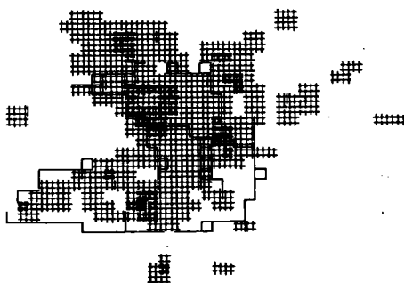
図6.16(2) 口径600mm以上を幹線としたときの全管網モデル
