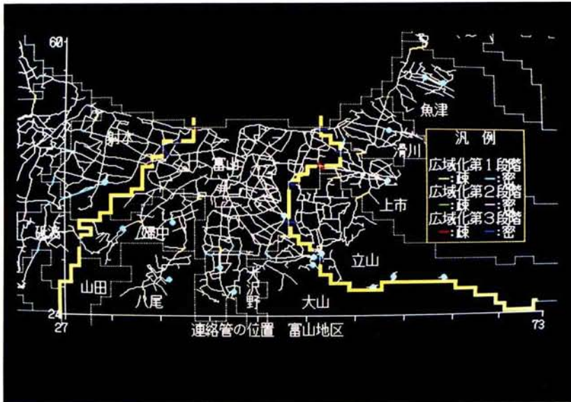
図7・1(c) 富山県中央部における主要管路図及び設定連絡管位置 広域化第一段階にて富山地区となる。
