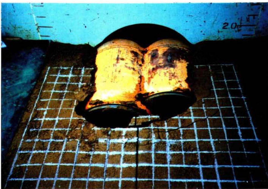
図5.3.5 正回転における切羽崩壊進行状況 ( v = 1 \text{ cm/min} , f = 8.2 \text{ rev/min} )
