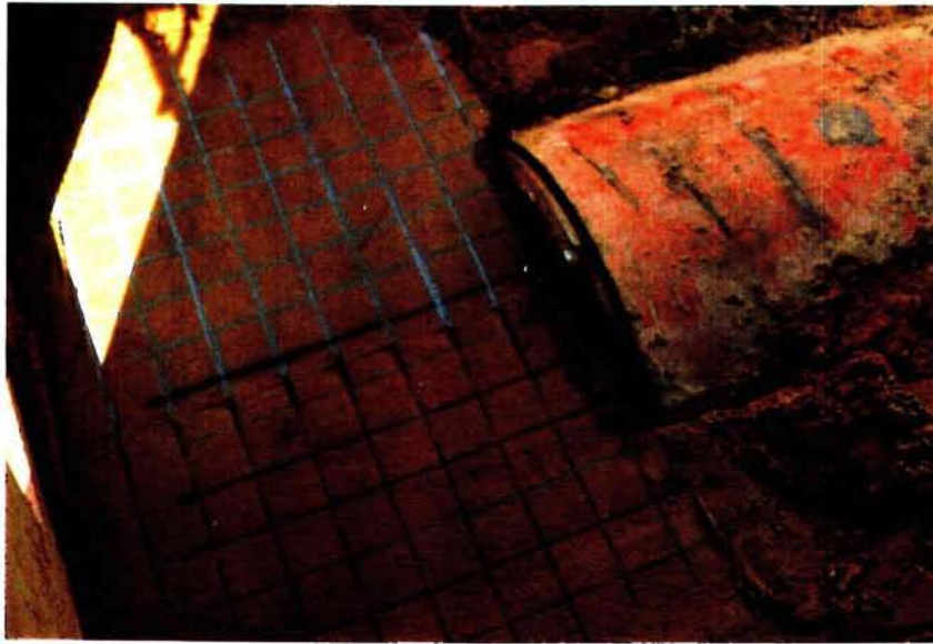
図3.5.1 目視実験状況 (硬地盤: v/f = 0.30 )
