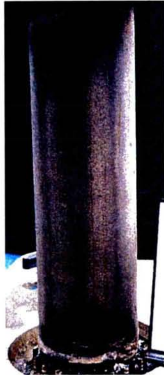
写真4.8.3 曲げ交番载荷試験B試験後破壊状況
