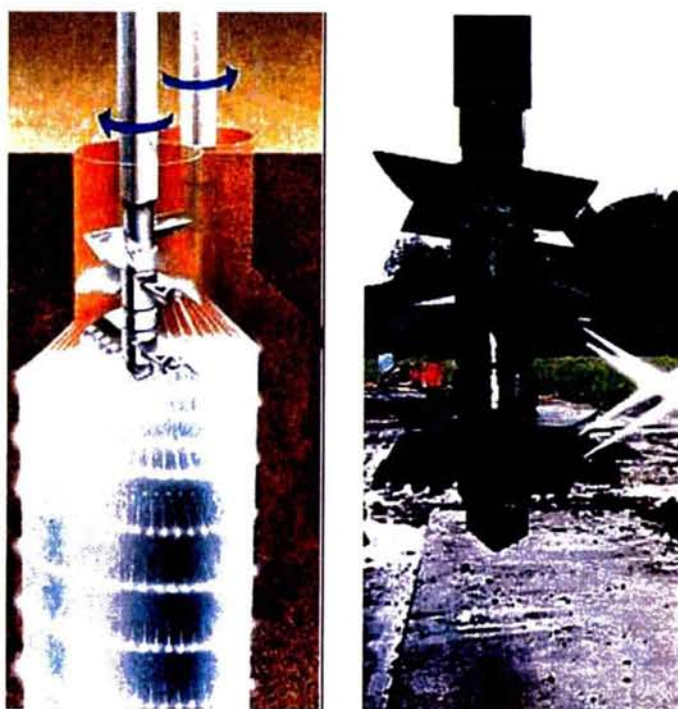
写真2.3.1 交差噴流式攪拌混合工法の概要
