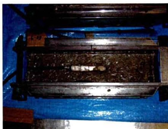
写真-5.2.3 低剛性ひずみ計設置状況
