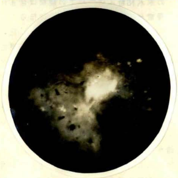
図-135 セメント・ペーストの結晶 内のヒヅワレ \times 1000
