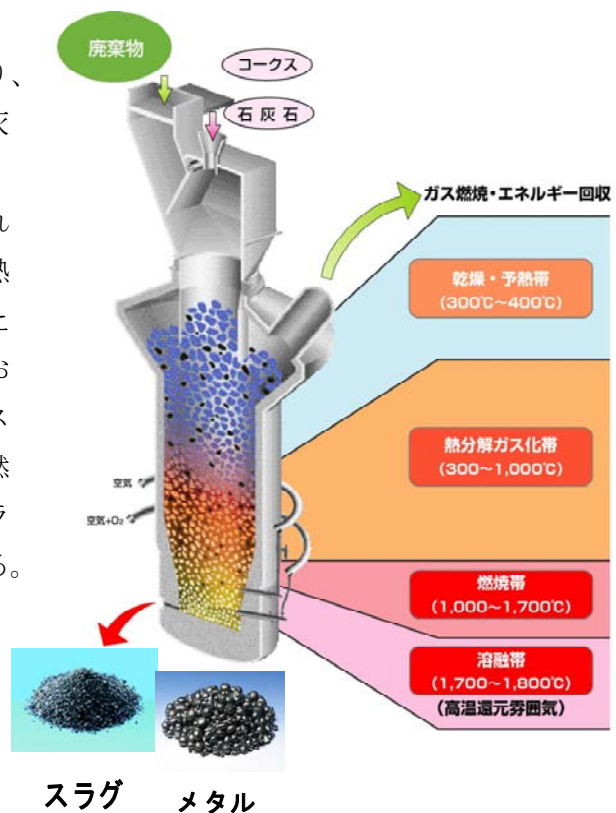
図 2.2-1 シャフト炉本体の処理プロセス
