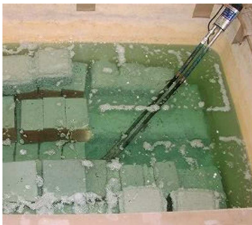
写真 5.2.1 酸性水浸漬試験状況
