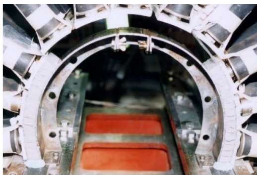
写真 3.2.1 ブロック積み覆工模型作製状況
