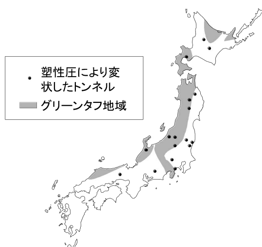
図 2.3.3 グリーンタフ地域と塑性圧により変状したトンネル 8)
