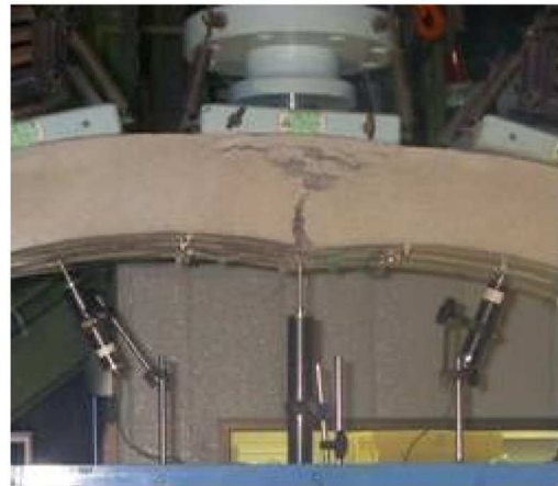
写真 4.3.2 ケース 6 の CFP 剥離に対するアンカーの効果
