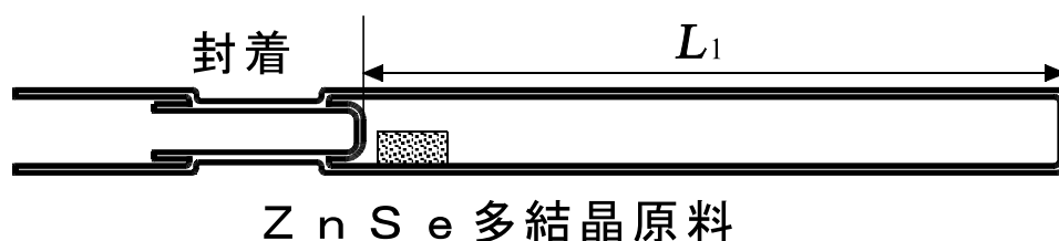
図 2-1 閉管アンブルの構造。ZnSe 多結晶原料が石英ガラス製の封管の中に充填されているだけの構造。輸送実験では、アンブル内の両端間の L_1 の距離だけ輸送される。
