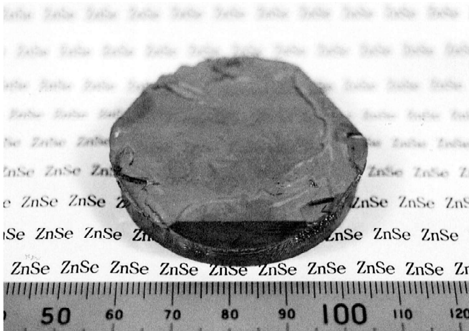
図 3-4 直径 2 インチ ZnSe 結晶の外観写真
