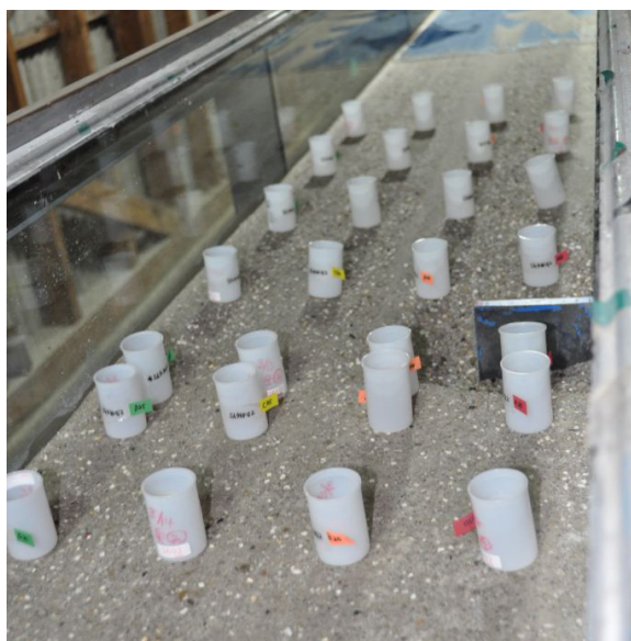
Fig. 3.12 河床表層の粒度分布調査
