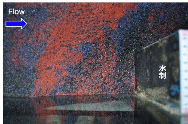
Fig. 3.29 Mix-CS ケースの水制周辺河床の粗粒化
