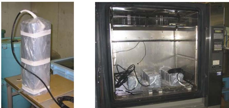
図 2-8 線膨張係数の測定（左：供試体の保水状況，右：恒温高湿槽設置状況）
