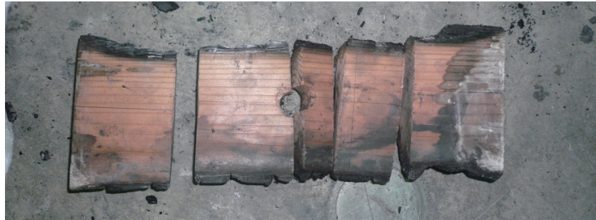
(a) 実験後試験体 F2 の片側木材 切断後
