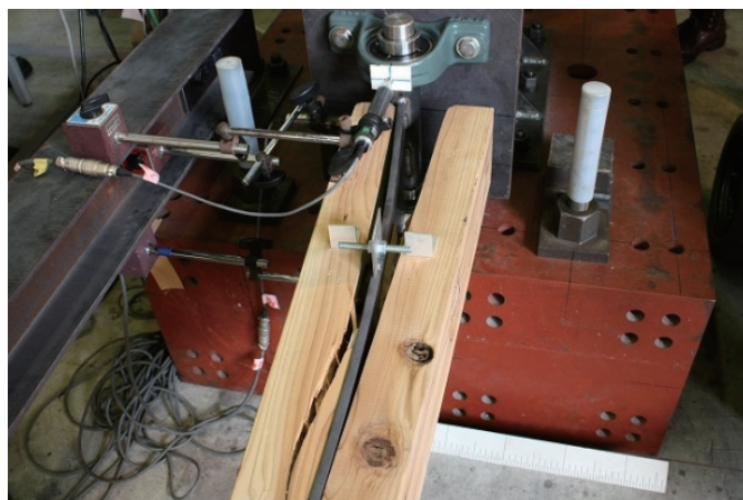
写真 3.5: 破壊性状 (試験体 C1)
