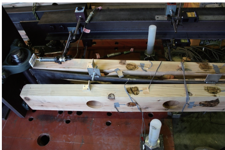
写真 3.6: 破壊性状 (試験体 C2)
