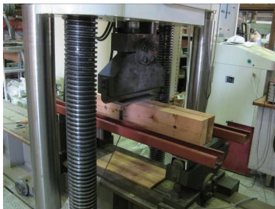
写真 4.2: 木材 3 点曲げ実験
