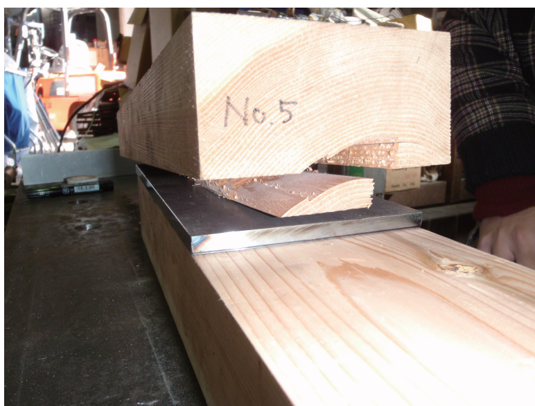
写真 2.2: はしあき破断
