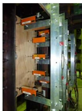
(b) 補剛材の面外変形測定
