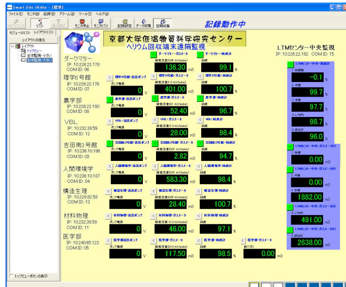
図 3: データ収集 PC のスクリーン上に表示された生データ。すべてのヘリウム回収室の状態が一目でわかる。
