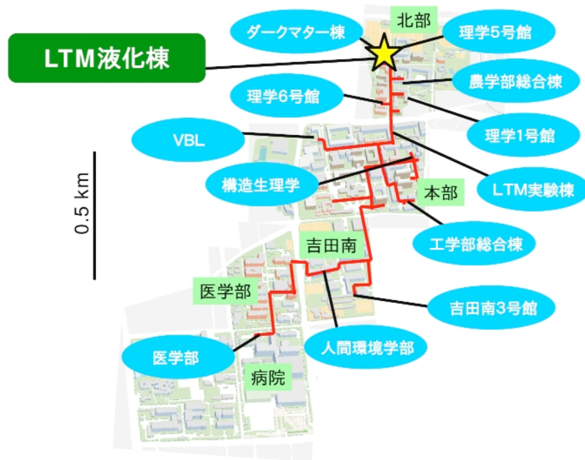
図 2: 京都大学吉田地区のヘリウム回収管網 (赤線). LTM センター液化棟を中心に総延長 3.5 km の回収管が整備されている. 学内各所の回収端末の場所も表示してある.
