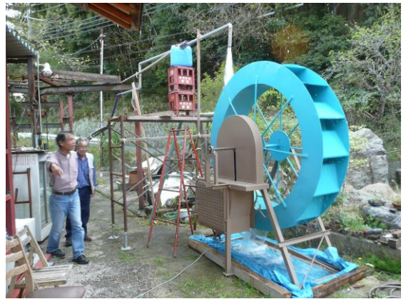
写真 6 製作した水車の発電テスト
