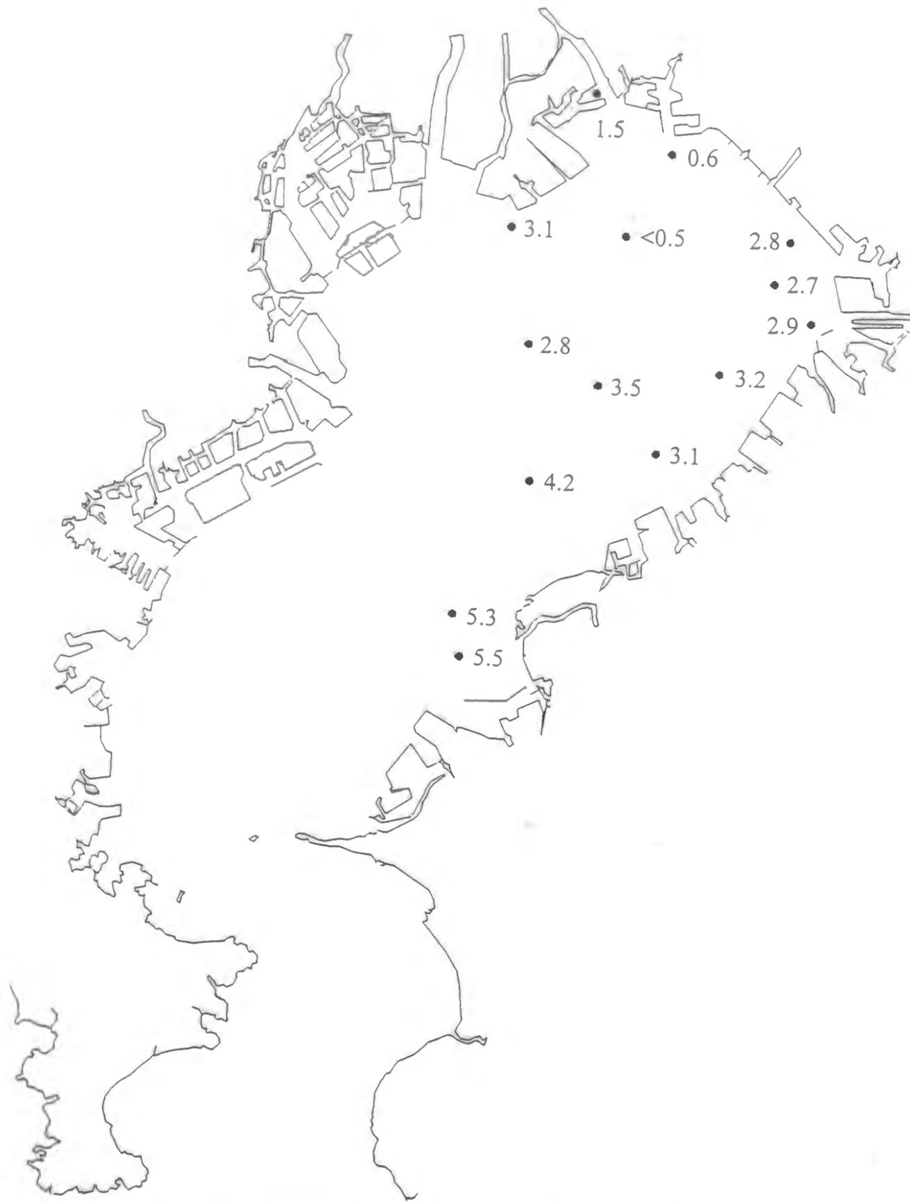
図-5.4.6(d) 溶存酸素濃度の水平分布 (底層における測定値 1989年10月3日)
