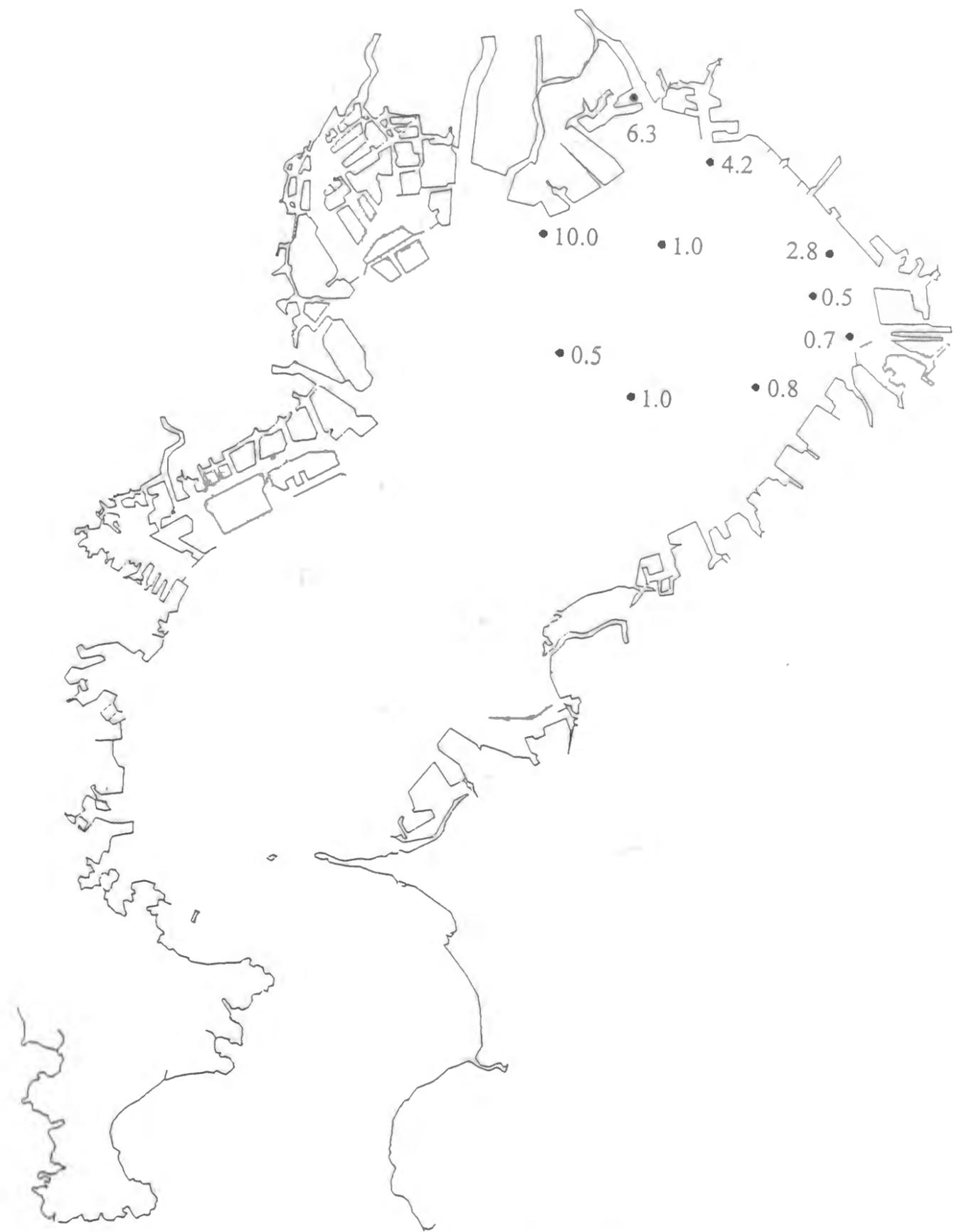
図-5.4.6(c) 溶存酸素濃度の水平分布 (底層における測定値 1989年9月27日)
