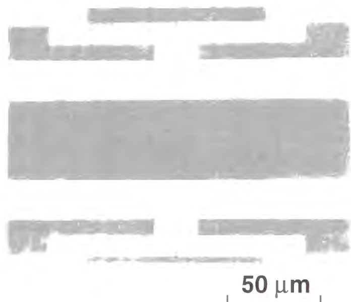
図5-7. 櫛形電極形成前のパターン例
