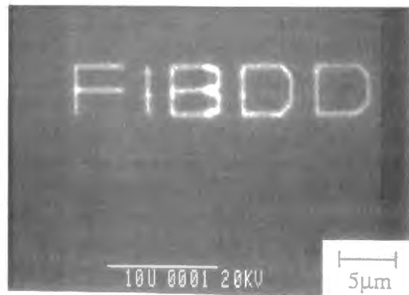
図2-12. 54 eVのAu + ビームによる直接蒸着例（走査電子顕微鏡像）
