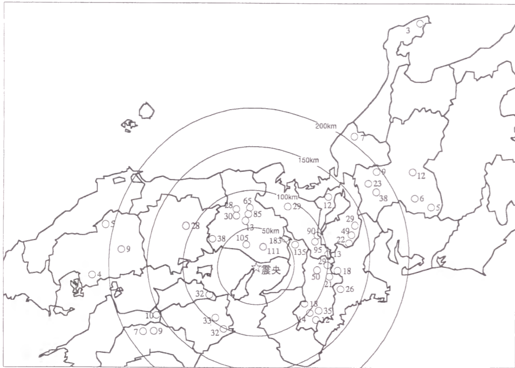
図-6.4.4 ダムサイト岩盤における水平最大加速度の分布
