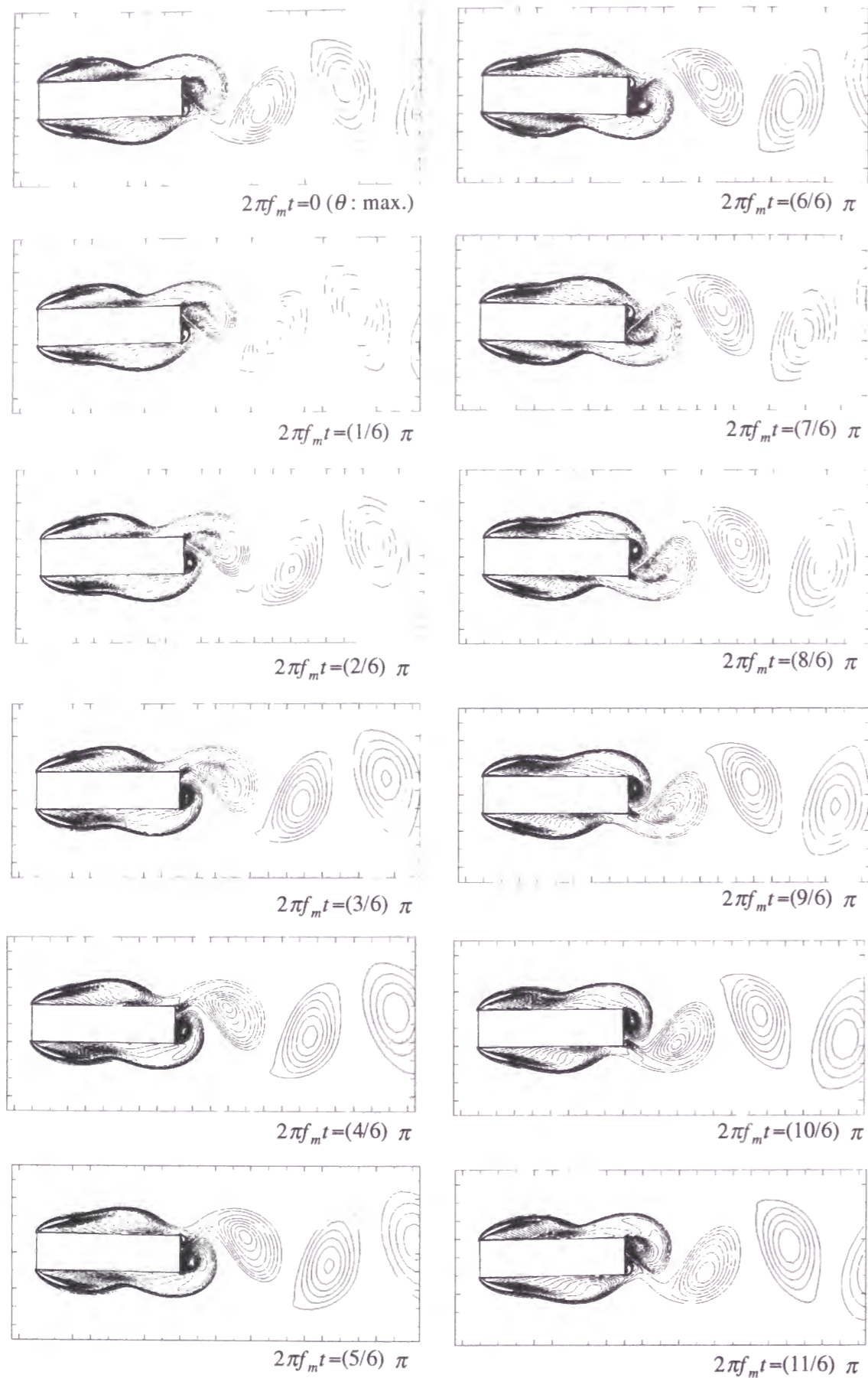
図6. 25 B/D=4.0 ねじれ自由振動時 ( Ur=5.67 ) の渦度の振動1周期間の時間変化
