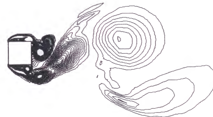
図 3. 3 B/D=1.0 矩形断面柱まわりの渦度場 ( 200 \times 100 )
