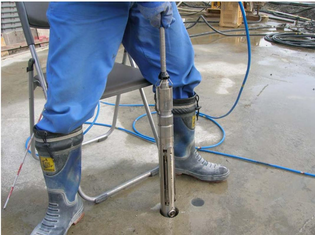
写真-2.1.6 試験ヤードにおける孔内打撃応答試験実施状況
