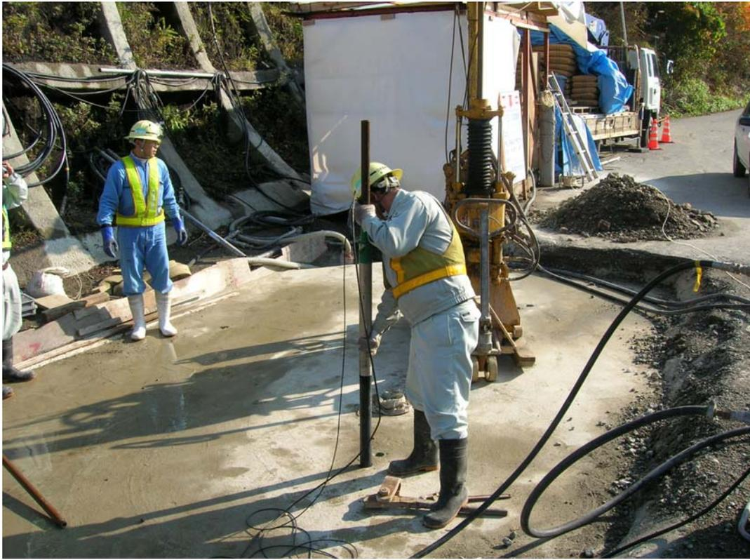
写真-2.1.5 試験ヤードにおける孔内载荷試験実施状況
