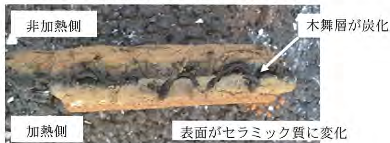
写真 2-1-1 加熱後の土壁断面(試験体 A-④)
