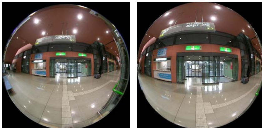
図 2-5 魚眼レンズでの撮影画像の変換例（左：等距離射影画像、右：変換後の正射影画像）
