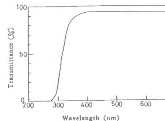
図3-4 硬質ガラスの紫外線の透過/吸収<sup>12)</sup>
