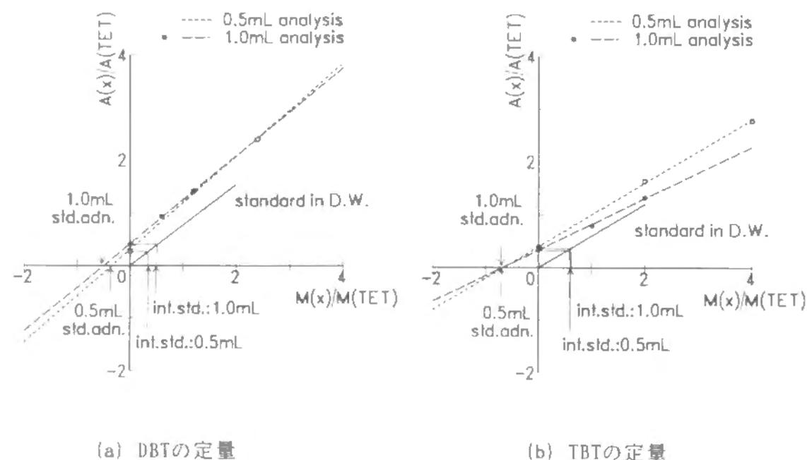
図2-8 底質抽出液の標準添加法による定量と蒸留水マトリックス（標準物質）の検量線
