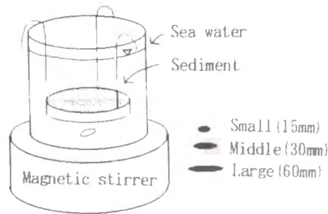
図4-7 境膜抵抗移動実験装置
