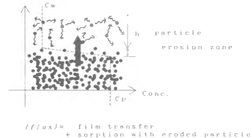
図4-13 収着—境膜抵抗移動モデル
