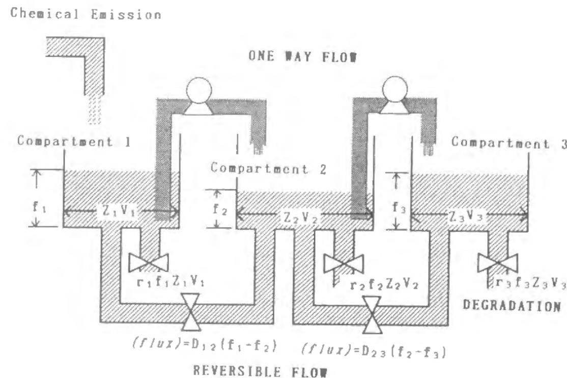
図5-1 tank analogy によるコンパートメントモデルの概念説明
