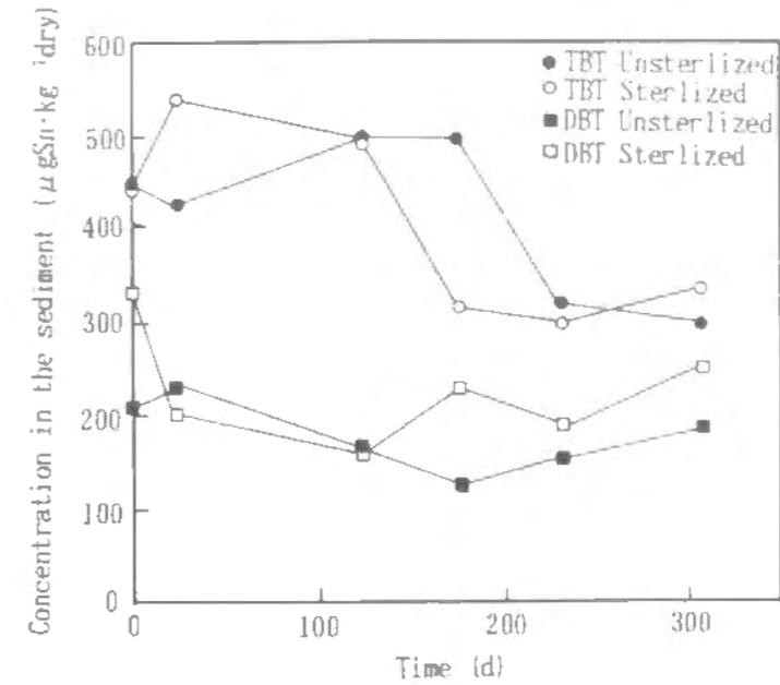
図3-17 嫌気状態の底質土中でのTBTの分解
