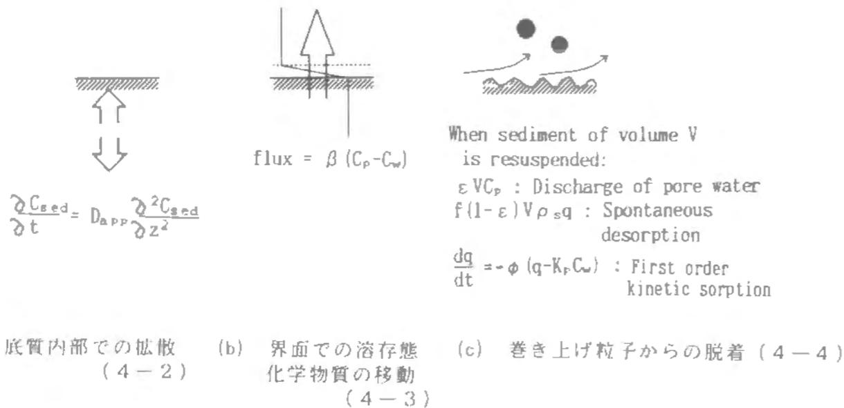
図4-1 水-底質系での化学物質の移動
