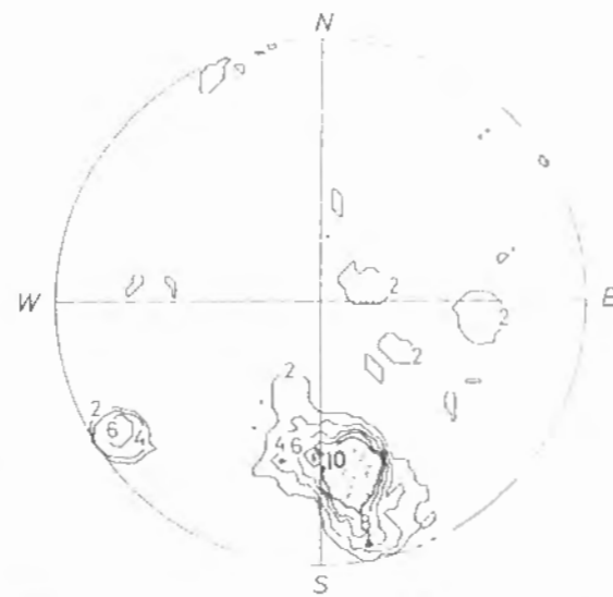
図6・12 採掘計画箇所内の露頭において観察された明瞭な節理の極の等密度線図(シュミットネット下半球投影)
