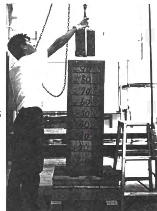
写真4・1 マサの体積と \gamma 線強度との関係に対する実験装置
