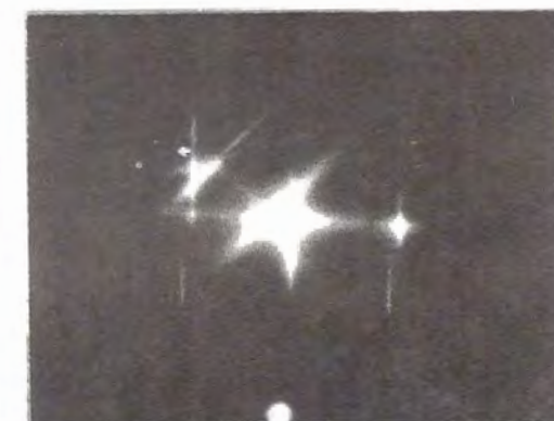
図4-9: (100)基板上へメタン濃度2、4、6、8%で形成したエピ膜の<110>および<100>入射による電子線回折像 メタン濃度: (a) 2%、(b) 4%、(c) 6%、(d) 8%
