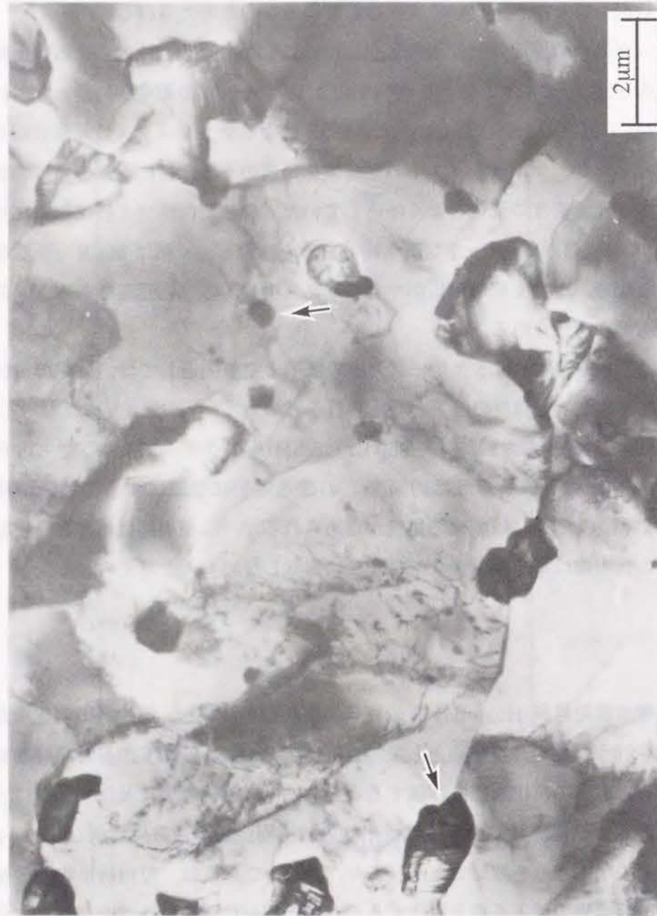
Fig.2.22 850°C 78.5MPaで15hのクリープ試験（通常の破断時間：40h）を行ったクリープ中断材の薄膜観察結果
