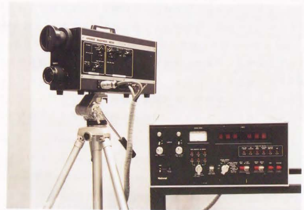
図2-16 順応輝度の計測装置
