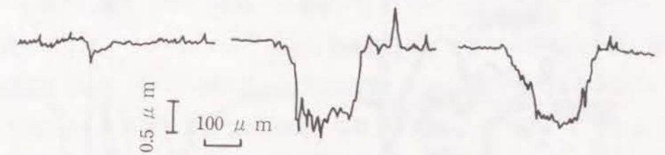
図7-11 イオンプレーティング法によって被覆したTiN皮膜の繰返し打撃に伴う表面損傷の進行
