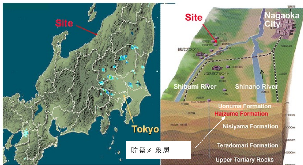
図 4.1.2 長岡プロジェクトの地点と地層構成
