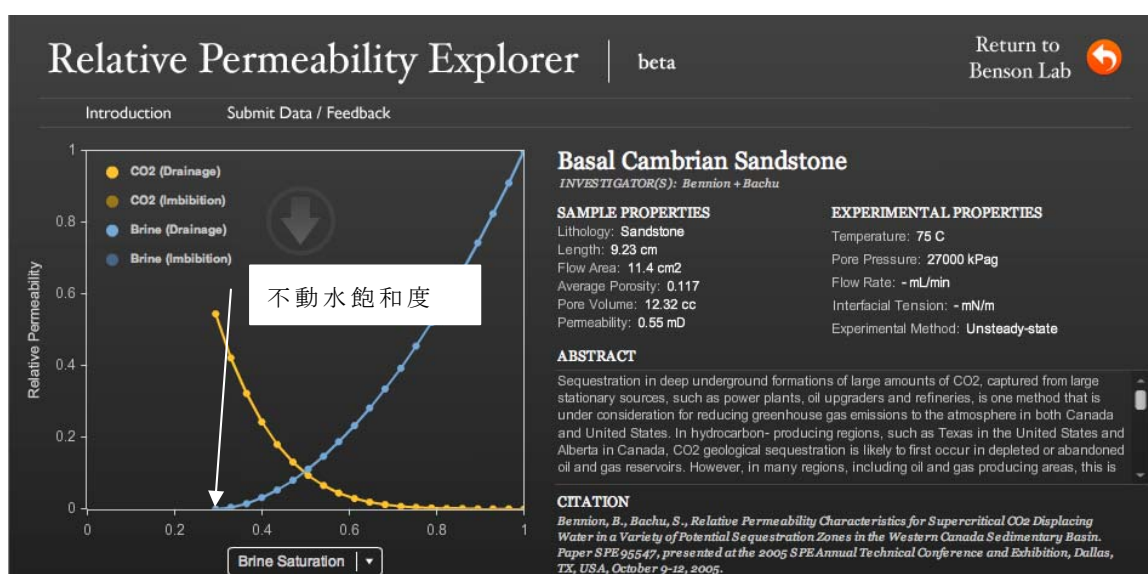
図 3.4.1 二相流移行シミュレーションに用いられる相対浸透率曲線の例
