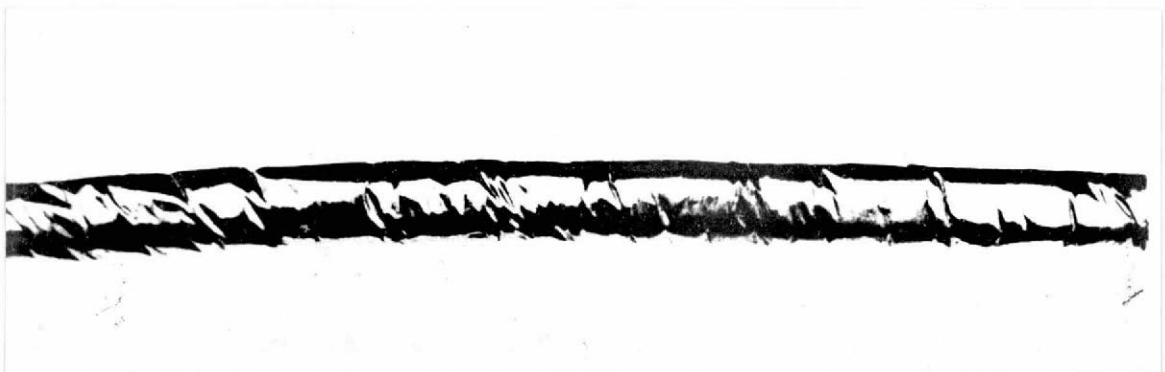
※ 51 図 ベルトケーブルの挫屈皺
