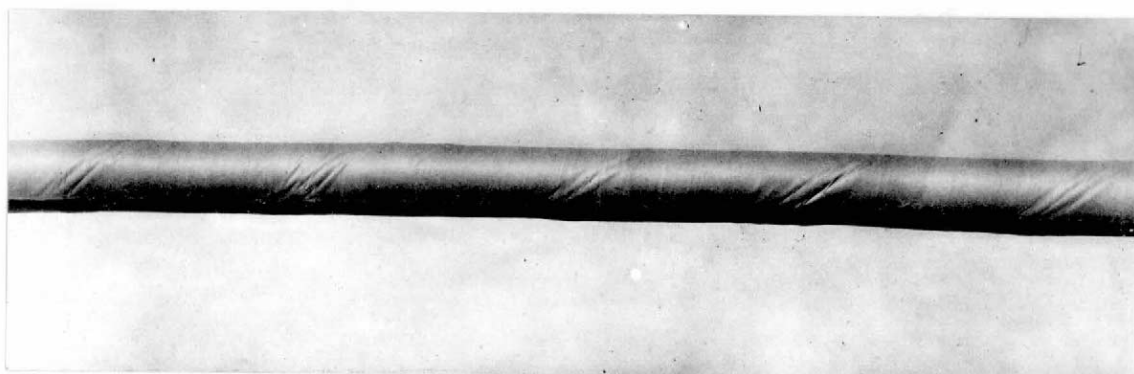
オ62図 捩り挫屈を生じた生紙円筒の断面
