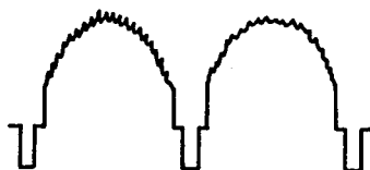
図 3.4 パラボラ・シェーディングのある場合の映像信号波形
