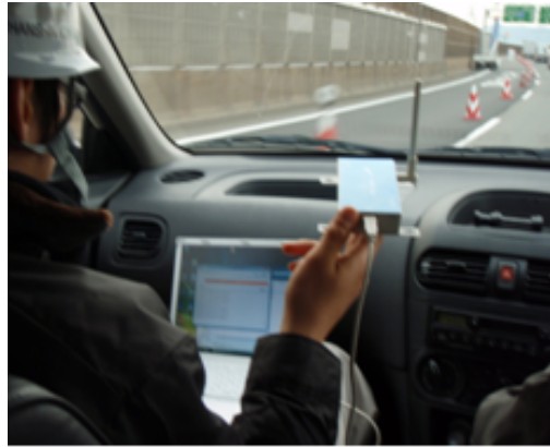
図 4.6 路車間無線通信により取得したデータの例 図 4.7 路車間無線通信中の走行車両内
