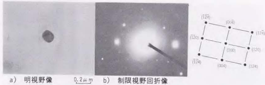
図2-1-8 中間焼鈍後に存在する微細粒子のTEM像と制限視野回折 (この微細粒子は約0.2 μmの径の \alpha' -AlFeSiである)
