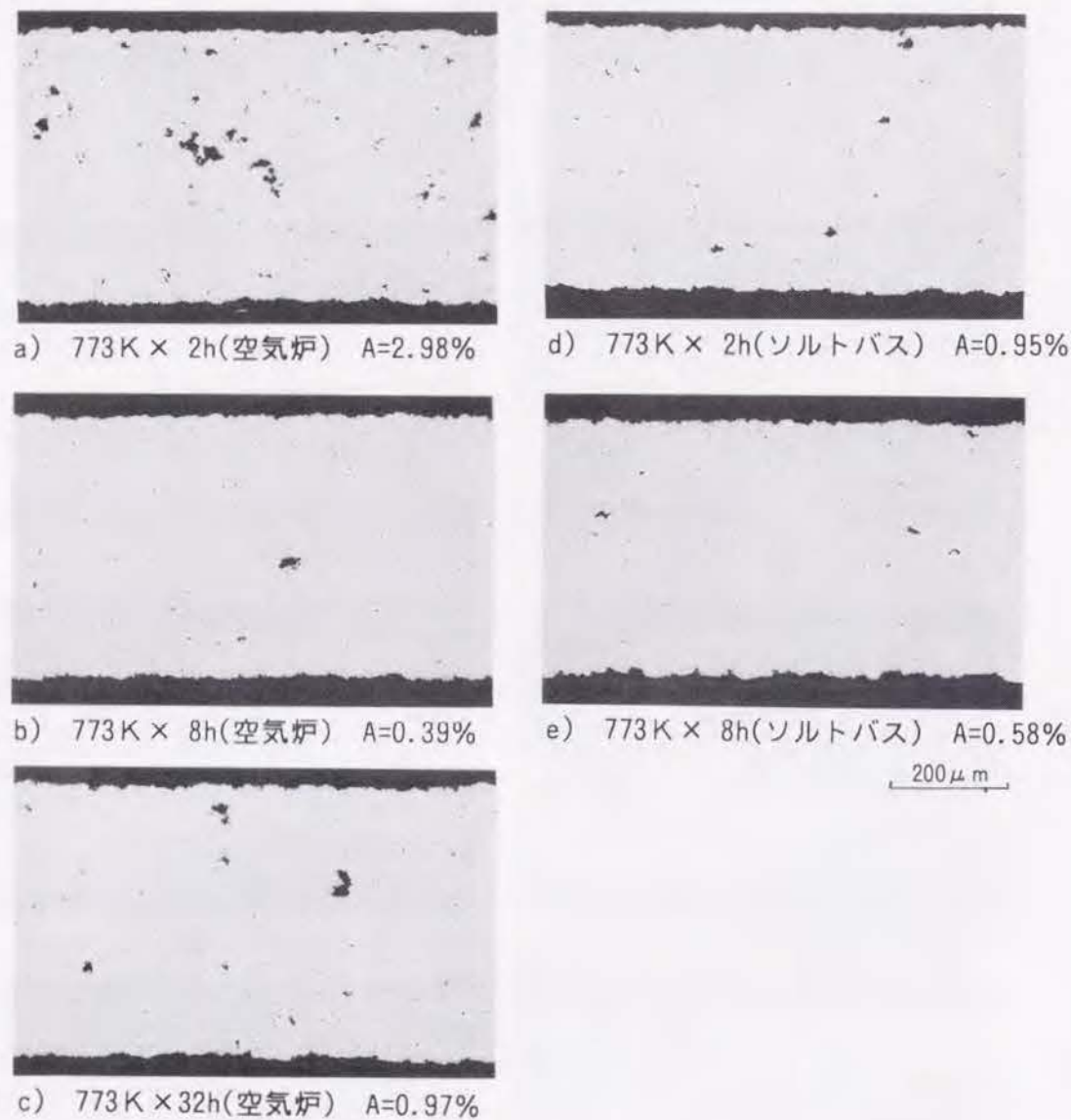
図4-2-16 キャビティ生成に及ぼす高温予備加熱時間の影響 (超塑性変形のひずみ量は約1.4, Aはキャビティの面積率を示す) 773K×32h(ソルトバス)は図4-2-15 g)と同じ
