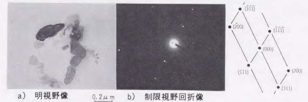
図2-1-6 リング状析出物のTEM像と制限視野回折
