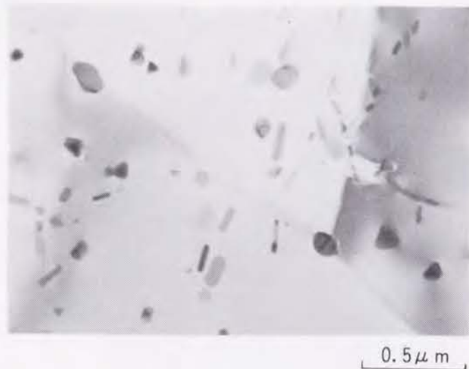
図3-1-21 0.22%Cr添加の三元合金(723K×24h均質化熱処理) T4材のクロム系化合物の大きさと分散状態
