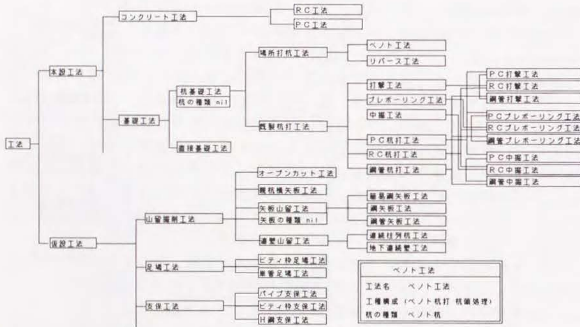
図-4.16 工法のフレーム構造 (一部)
