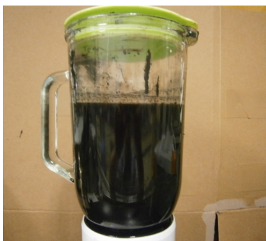
図 4.3 凝集前の外観 (水熱処理炭の水スラリーに溶剤を加えた状態)
