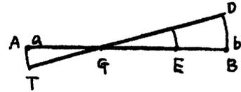
この A と E に同じ重さの錘を下げると線は当然水平面に平行になる。E の錘を B に移動したとき天秤竿を平行に保つためには、A にさらに錘を加えねばならない。「点 B の力は点 A の力を、BG が AG を超過するだけ超過するので、より強い力の点の錘はより弱い力の点の錘より小さい。よって A 点の錘 a 対 B 点の錘 b の比は、GB 対 AG となる」。その後数値例が示される。
