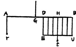
AB が支点 G で不等に二分されるとし、「点 A に錘 r が付けられ、線 GB のうちの一部の線 DB で、鉛直棒の厚さがそうであるように、全体にわたって一様に単純に連続的に定められた錘がつり下げられる」。つまり DB に DBUE という平面形の錘がつり下げられ、釣り合いが取れているとする。そのとき、この平面錘 DBEU を取り除き、それを DB の中間点 H に集め単一の錘 t としても AB は釣り合ったままになることを言う。『カラストゥーンの手紙』の最も重要な命題である。
