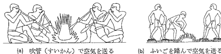
図 1.4 金属の溶解、鑄造を容易にしたふいごの発明 6)
