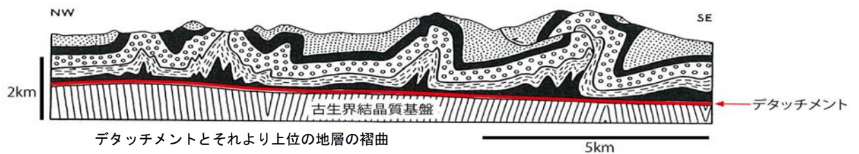
図 3-20 デタッチメント褶曲の例 (狩野・村田, 1998 に加筆)
