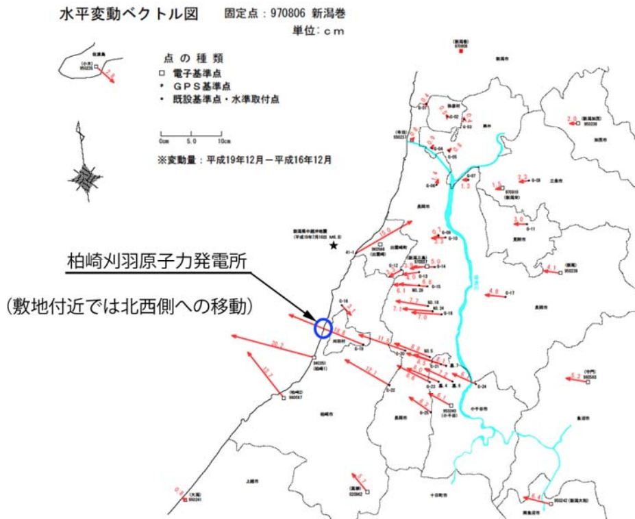
図 4-6 東京電力によるGPS測量結果（水平成分）
