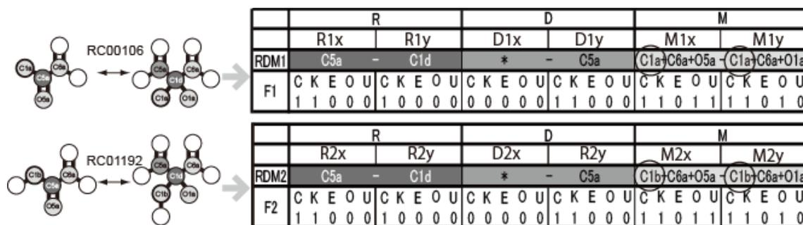
図 3-1 RDM 表記のフィンガープリント表記への変換
