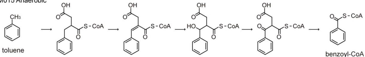
図 4-10 トルエン分解における好氣性モジュール RM003 と嫌氣性モジュール RM015 の比較
