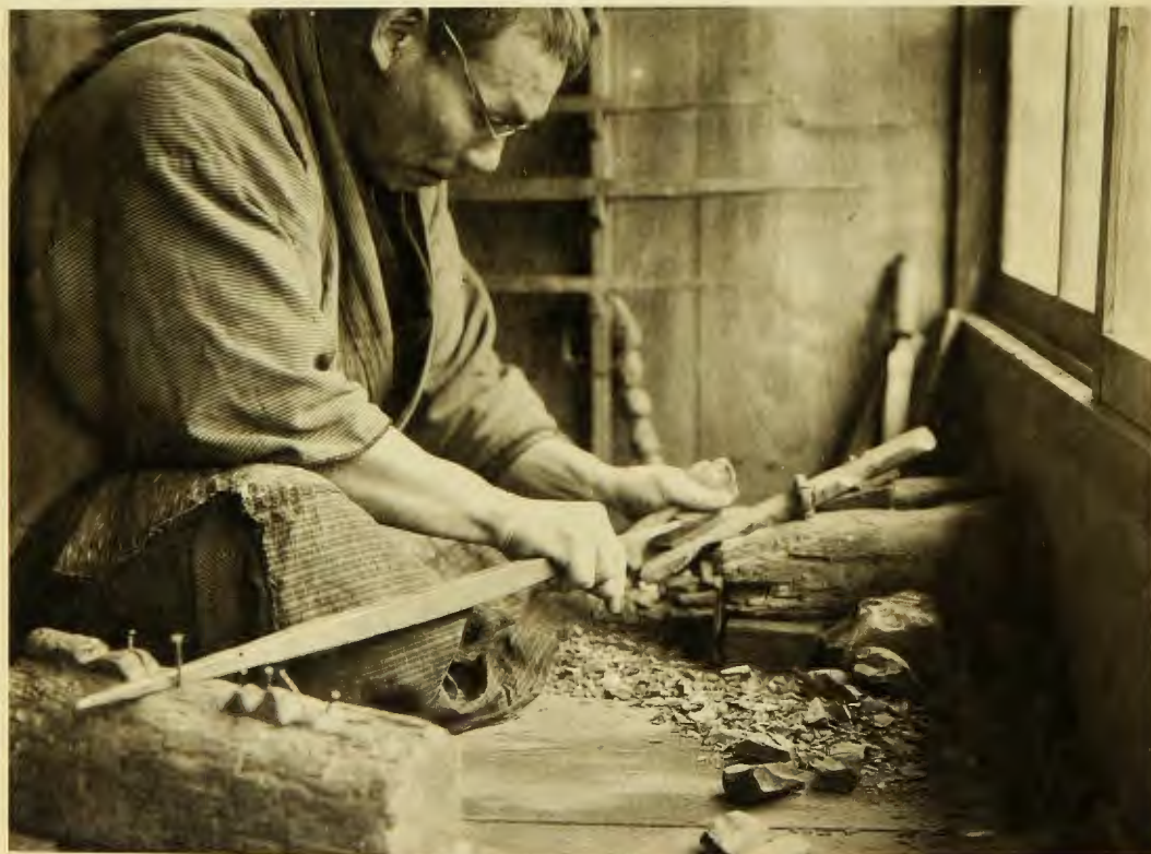
(2) 「罫金」を以て石材をコギ破る
