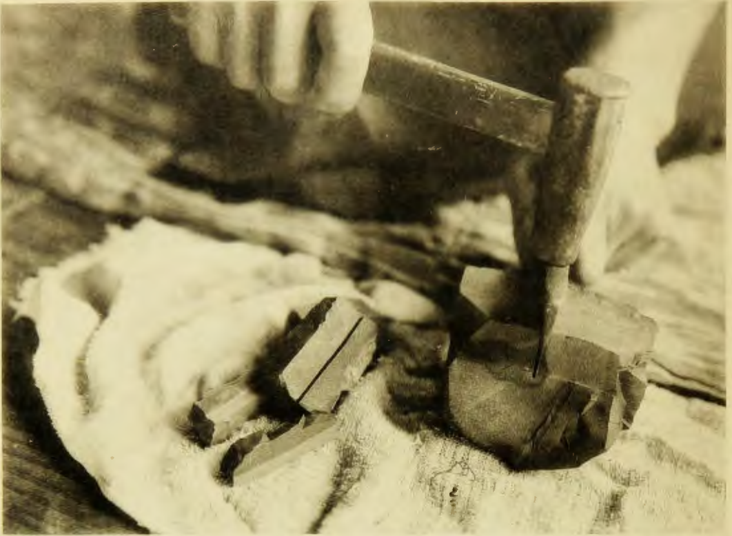
(1) 「筋」の中に「矢」を挿入して破碎す
