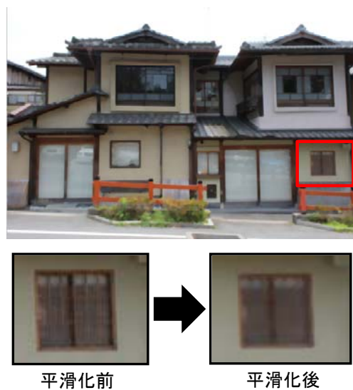
図-12 メディアンフィルタによる平滑化画像例 (Img5)
