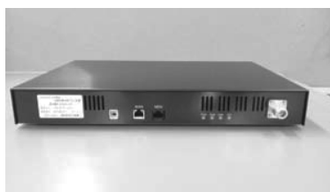
図2：UHF帯（470-710MHz帯、1W）広域広帯域無線通信機。
