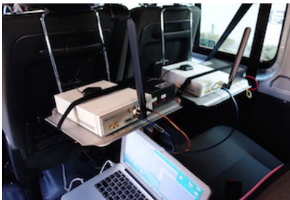
図 7 車内に設置した移動局装置及び車内配置図
