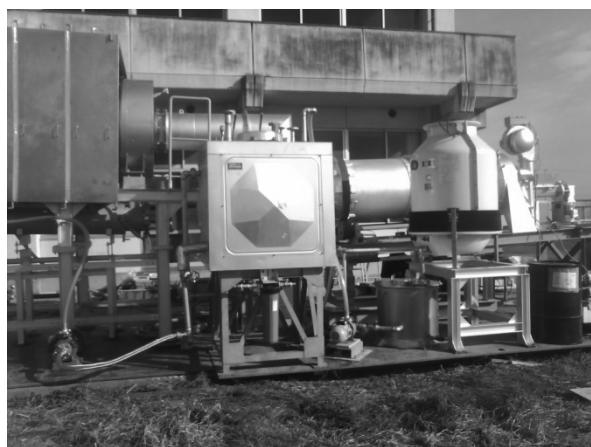
図 1 現地に設置されたマイクロ波-燃焼ハイブリッド加熱炉。
