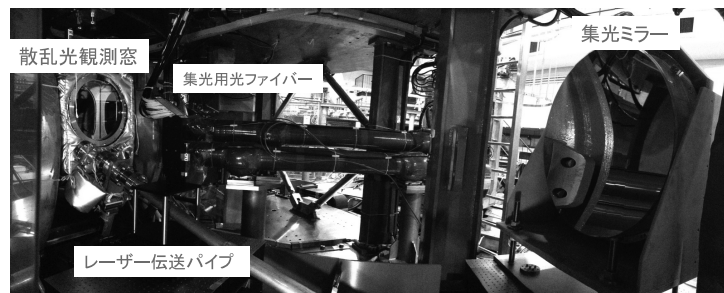
図1 トムソン散乱計測システムの入射及び集光部。
